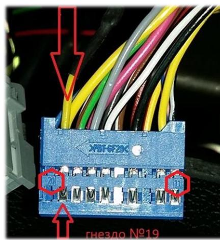
**Внимание!** В пучке проводов разъема панели приборов есть два черных с белой полосой провода, имеющих разное назначение! Гнездо №11, синий блок – «датчик скорости» и гнездо №39, белый блок клемм – « дальний свет фар». Подключаться необходимо к черному с белой полосой проводу, идущему к синему блоку!
